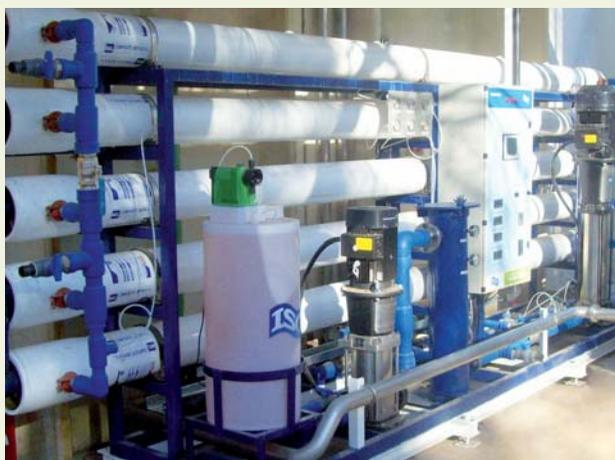
**Figura 2 - Equipo desmineralizador por ósmosis inversa**
