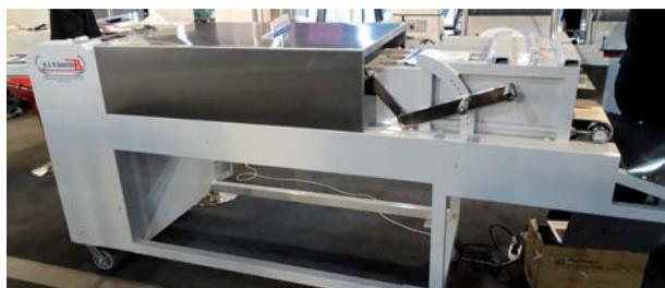
Arma pan de miga de hasta 12 kg, también sirve para elaborar pan lactal. De rápido desgasificado y armado, reduce el tiempo de sobado de la masa.
