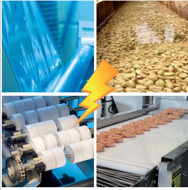
FIGURA 1 - Distintas maneras de generar estática en una fábrica. Rollos de material envase. Rozamiento de producto. Rodamientos. Cintas transportadoras.
